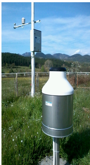
Фиг. I.5 Автоматична метеорологична станция за интензивност на валежа състояща се от тегловен датчик за валеж, датчик за температура и относителна влажност на въздуха, датчик за слънчева радиация
