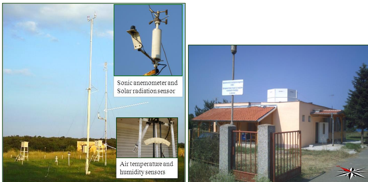
Фиг. 3.4.1. Тримерен акустичен анемометър със сензор за слънчева радиация монтирани на метеорологична мачта на височина 4.5 m, сензор за температура на атмосферния въздух в стандартна метеорологична клетка (дясна снимка: част от оборудването на АМС МК-15) и содар (лява снимка: Scintec Flat Array Sodar MFAS) находящ се на покрива на административната сграда на МО Ахтопол. Тестови измервания на инсталираната апаратура от 18 до 20 юли 2008 г.
