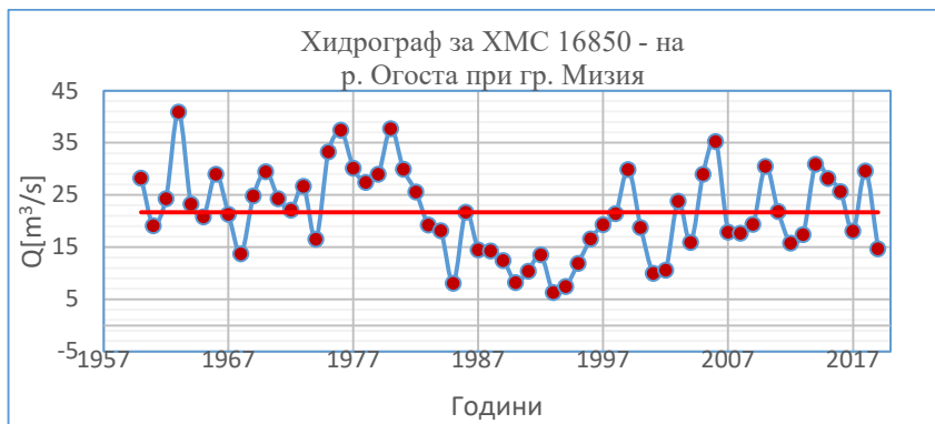
Фиг. 4.5.2 Хидрограф на средногодишните водни количества за ХМС 16850 на р. Огоста при гр. Мизия
