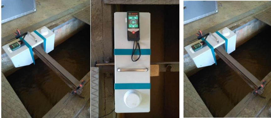
Фиг. 19. Разположение на скоростомера RP-30 над водната повърхност в експерименталния канал на Лабораторията по хидравлика.
