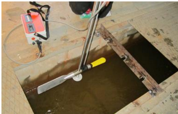
Фиг. 12 Подготовка за контролните измервания със скоростомера Nautilus C 2000 в моделния канал на Лабораторията по хидравлика на НИМХ.
