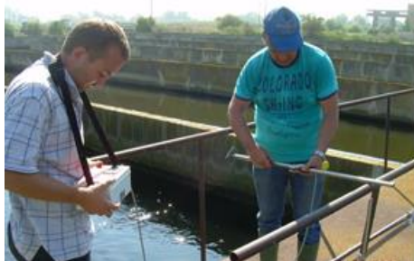
Фиг. 16. Момент от измерването на водно количество със скоростомер Nautilus C 2000 в изходящия канал на СПСОВ "Кубратово".
