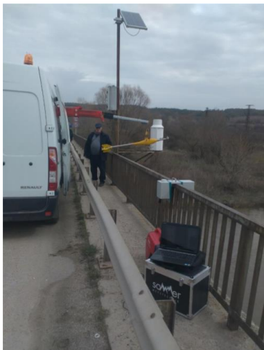
Фиг. 25. Измеренията на водното количество на р. Янтра от моста на ХМС № 23850 – р. Янтра при с. Каранци със скоростомера RP-30
