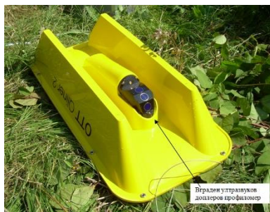
Фиг.38.Разположение на сензорите в дъното на катамаранчето.
