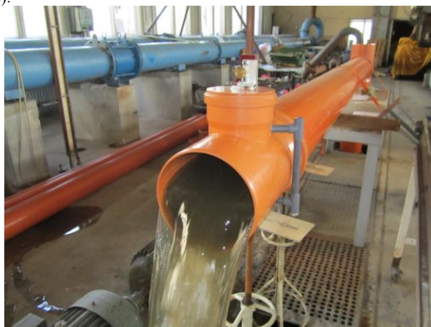
Фиг. 6.2 Изпитателен стенд за безнапорни хидрометрични съоръжения.
