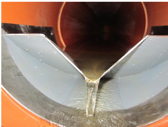
Фиг. 6.3 Безвакуумен режим на преливането при малки дебити.
