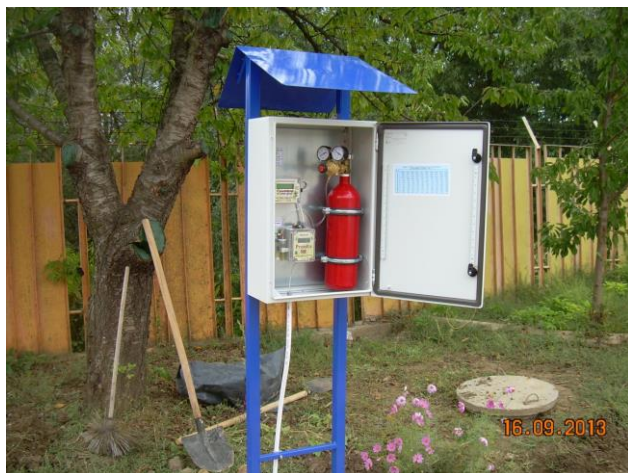
Фиг. 7.2 Електронна регистрираща апаратура за съвместна работа с хидрометричното съоръжение.
