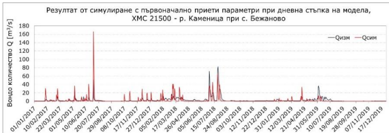
фиг. IV.1.9 Първоначален резултат от моделиране на водното количество при ХМС 21500 – р. Каменица при с. Бежаново; стъпка на модела 24h
