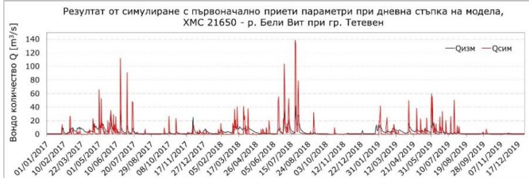
фиг. IV.1.8 Първоначален резултат от моделиране на водното количество при ХМС 21360 – р. Бели Вит при гр. Тетевен; стъпка на модела 24h
