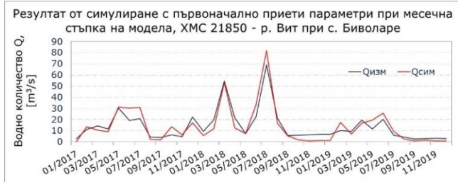
фиг. IV.1.6. Първоначален резултат от моделиране на водното количество при XMC 21850 – р. Вит при с. Биволаре, месечни стойности
