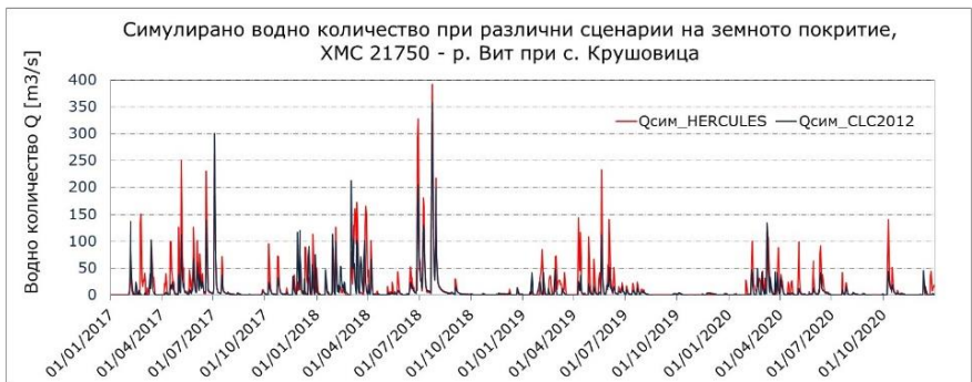
фиг. V.3.1.4. Моделирани ежедневни водни количества със сценарии на земно покритие HERCULES и CLC2012 за подводосбор #23
