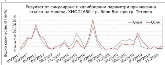
фиг. IV.3.2. Резултат от симулиране на водното количество при ХМС 21650 – р.Бели Вит при гр. Тетевен с калибриран модел; месечна стъпка
