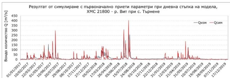
фиг. IV.1.11. Първоначален резултат от моделиране на водното количество при ХМС 21800 – р. Вит при с. Търнене; стъпка на модела 24h
