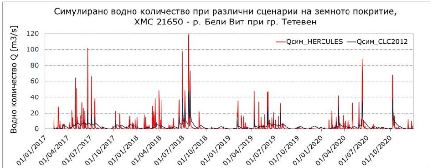
фиг. V.3.1.3. Моделирани ежедневни водни количества със сценарии на земно покритие CLC2012 и HERCULES за подводосбор #36
