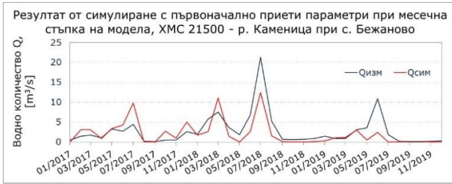
фиг. IV.1.3. Първоначален резултат от моделиране на водното количество при XMC 21500 – р. Каменица при с. Бежаново, месечна стъпка на модела
