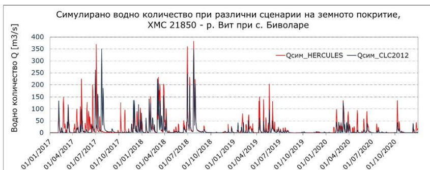
фиг. V.3.1.6. Моделирани ежедневни водни количества със сценарии на земно покритие HERCULES и CLC2012 за подводосбор #5
