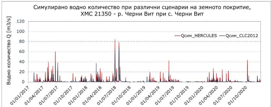
фиг. V.3.1.2. Моделирани ежедневни водни количества със сценарии на земно покритие CLC2012 и HERCULES за подводосбор #38
