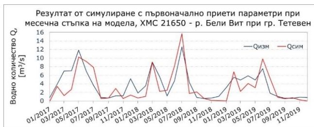
фиг. IV.1.2. Първоначален резултат от моделиране на водното количество при ХМС 21650 – р. Бели Вит при гр. Тетевен, месечна стъпка на модела
