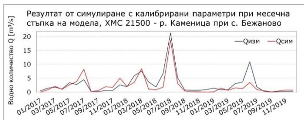
фиг. IV.3.4 Резултат от симулиране на водното количество при ХМС 21500 – р.Каменица при с. Бежаново с калибриран модел; месечна стъпка
