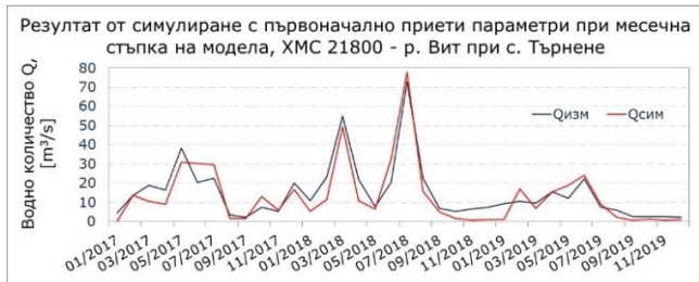
фиг. IV.1.5. Първоначален резултат от моделиране на водното количество при XMC 21800 – р. Вит при с. Търнене, месечна стъпка
