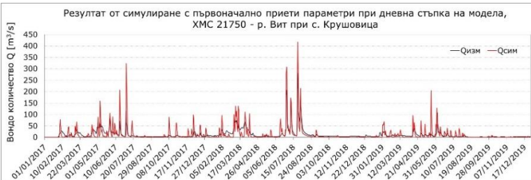
фиг. IV.1.10 Първоначален резултат от моделиране на водното количество при ХМС 21750 – р. Вит при с. Крушовица; стъпка на модела 24h
