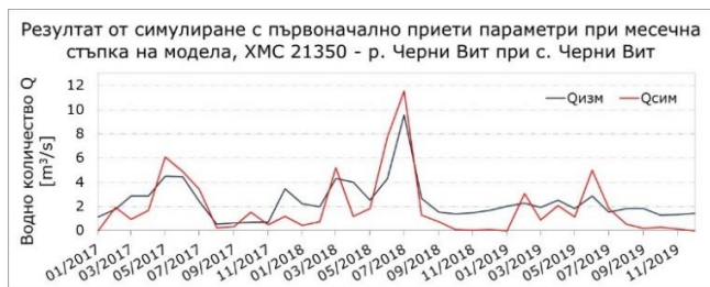
фиг. IV.1.1. Първоначален резултат от моделиране на водното количество при ХМС 21350 – р. Черни Вит при с. Черни Вит, месечна стъпка на модела
