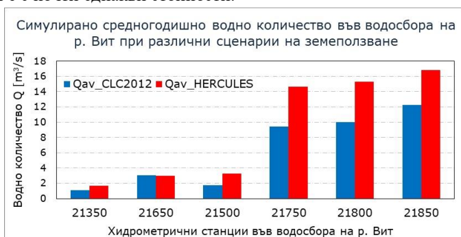
фиг. V.3.1.1. Симулирано средногодишно водно количество във водосбора на р. Вит при сценарии на земното покритие CLC2012 и HERCULES.
