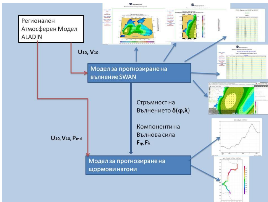
Фиг.11. Схематично представяне на функционирането на оперативната система за прогнозиране на вълнение и щормови нагони с висока пространствена разделителна способност за българското крайбрежие на Черно море.
