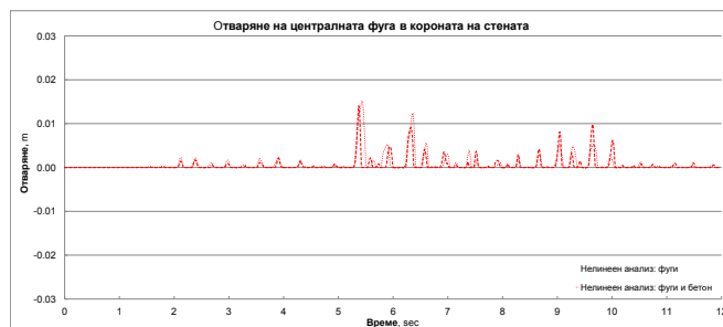
Фигура 7.10: Яз.ст. „Morrow Point”. Отваряния на фугата в центъра на короната на стената [m]
