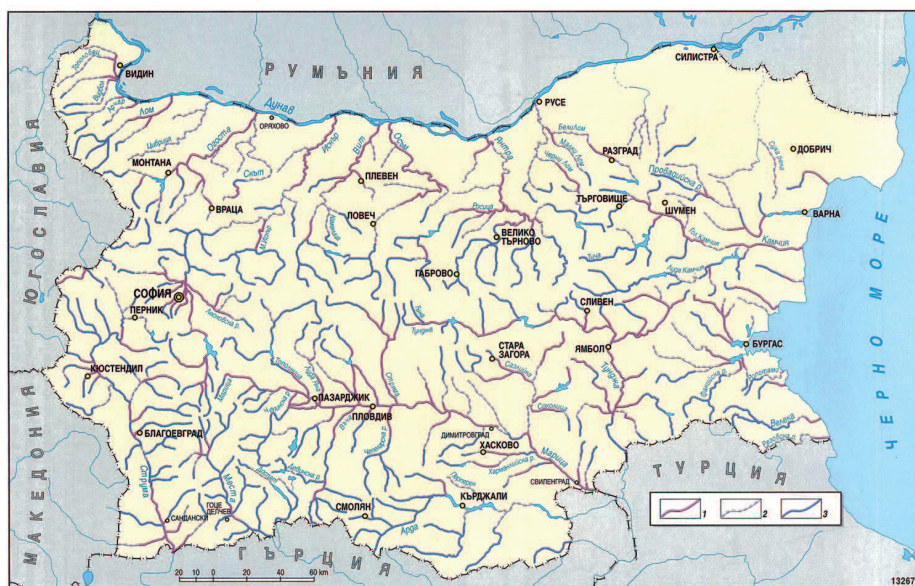
Класификация на речната мрежа в зависимост от типологията на русловите процеси (по Гергов, 1974). 1 – свободно меандрираща река; 2 – ограничено меандрираща река; 3 – немеандрираща река.
