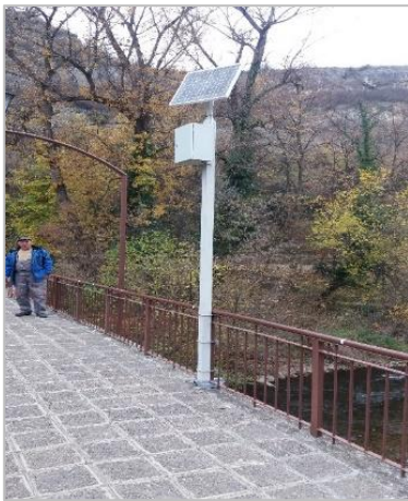
Фиг.9.7.2. Монтиране на нови автоматични хидроложки станции: а) АХС 23150 р. Голяма при гр. Стражица; б) АХС 22750 р. Осъм при гр. Ловеч
