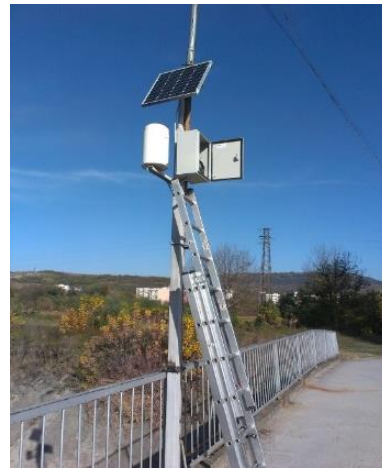
Фиг.9.7.2. Монтиране на нови автоматични хидроложки станции: а) АХС 23150 р. Голяма при гр. Стражица; б) АХС 22750 р. Осъм при гр. Ловеч
