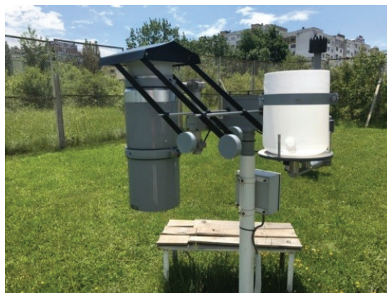
Фигура 5. Автоматично пробовземашо (wet and dry only) WADOS (Kroneis GmbH), инсталирано в ЦМО София.
